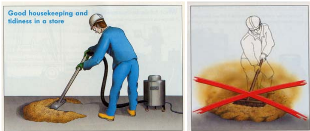
Afb. 3.2: Verwijdering van stofafzetting. 4
